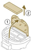
4 Oplucz filtr wodą i pozostaw go do wyschnięcia na powietrzu.
