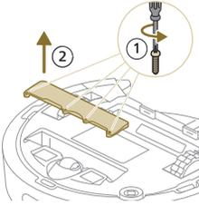
3 Draai de schroeven van het deksel van het accucompartiment los en verwijder het deksel.
