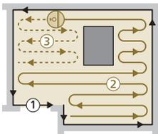
Robot čistí domácnost strukturovaným způsobem. Robot čistí místnost po místnosti a vždy začíná čištěním okrajů místnosti, než přejde na zbývající část podlahy.
