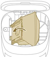
5 Vuelve a colocar el soporte de la bolsa en posición vertical hasta que oigas un "clac".
