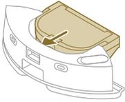
8 Fyld vandtanken via vand indtaget. Placer vandtanken på det korrekte sted.
