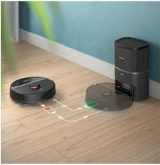
Wenn der Akku fast leer ist (<20 %), während der Roboter reinigt, fährt er automatisch zur Station zurück, um sich wieder aufzuladen. Nach dem Aufladen des Akkus fährt der Roboter mit der Reinigung fort, wo er aufgehört hat.
