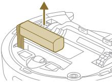
4 Til de oplaadbare accu uit het accucompartiment en koppel hem los door op het kleine klemmetje op de accuaansluiting te drukken zodat de accuaansluiting loskomt.
