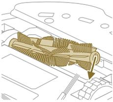
**8** Nasadte hlavní kartáč na správné místo. Zarovnejte čtvercový kolík proti odpovídajícímu čtvercovému otvoru a vložte kartáč na místo.
