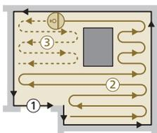
Robot puhastab kogu kindla skeemi järgi. Robot puhastab ruumi ükshaaval ja alustab alati ruumi servade puhastamisest ning jätkab seejärel ruumi muude aladega.
