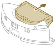
2 Öffnen Sie den Deckel des Staubbehälters, und leeren Sie den Schmutz aus dem Staubbehälter.
