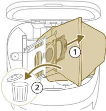
4 Skjut in dammpåsens kartongdel på påshållaren.
