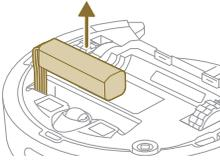
4 Extraiga la batería recargable y desconéctela presionando el pequeño clip del conector de la batería para soltar el conector de la batería.
