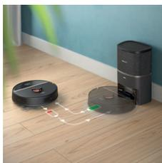
Kui aku hakkab puhastamise ajal tühjenema (< 20%), liigub robot automaatselt tagasi laadimisjaama akut laadima. Kui aku on laetud, jätkab robot tööd seal, kus see enne laadimist pooleli jäi.
