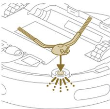
**2** Piestipriniet mazgāšanas suku paliktņa turētāju robota ūdens tvertnes apakšdaļai.
