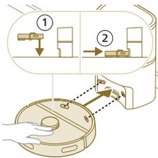
3 Lükake robot vastu jaama nii, et roboti laadimispistik puutuksid kokku jaama laadimispistikuga.
