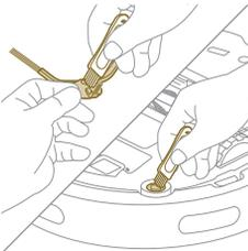
1 Legen Sie den Roboter umgekehrt auf eine ebene und stabile Oberfläche.
