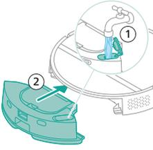
8 Llena el depósito de agua a través de la entrada de agua. Inserta el depósito de agua en la ubicación correcta.
