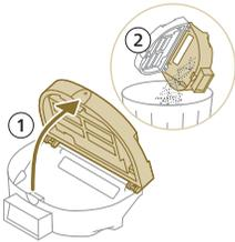
3 Відкрийте кришку фільтра та вийміть повітряний фільтр.
