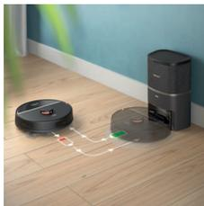
Quand le niveau de la batterie est faible (< 20 %) en cours de nettoyage, le robot retourne automatiquement à la station pour se recharger. Une fois la batterie chargée, le robot reprend la session là où il s'était arrêté.
