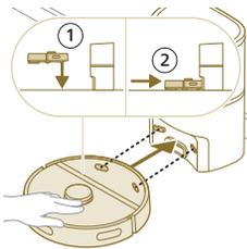
3 Skyv roboten mot stasjonen slik at ladekontaktene på roboten berører ladekontaktene på stasjonen.
