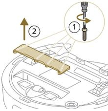
3 Ta bort skruvarna på batterifacket lock och ta bort locket.
