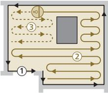
Robot czyści dom w uporządkowany sposób. Robot czyści pomieszczenia po kolei i zawsze zaczyna od czyszczenia skraju pomieszczenia przed przejechaniem po pozostałej powierzchni.
