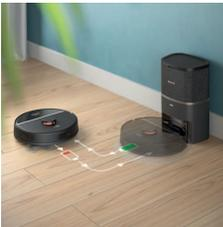
Når batteriet blir lavt (<20 %) under rengjøring, vender roboten automatisk tilbake til stasjonen for å lades opp. Etter at batteriet er ladet opp, fortsetter roboten der den slapp.
