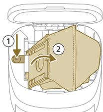
2 Pritisnite gumb za sprostitev in potisnite nosilec vrečke na stran.
