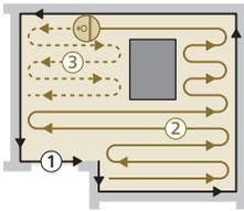
Roboten rengjør hjemmet på en strukturert måte. Roboten rengjør ett rom av gangen og starter alltid med å rengjøre kantene av rommet, før den dekker den gjenværende overflaten.
