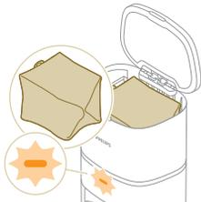
Quando il sacchetto per la polvere è pieno, il LED arancione sulla stazione di svuotamento automatico lampeggia.
