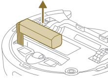
4 Puxe a bateria recarregável para fora e desligue-a, carregando no pequeno clipe no conector da bateria para libertar o conector da bateria.
