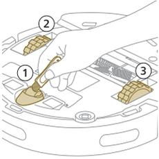
2 Per rimuovere polvere e lanugine dalla ruota anteriore e dalle ruote principali, utilizzate una spazzola a setole morbide (ad esempio, uno spazzolino da denti).
