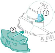
8 Fyll på vannbeholderen fra vanninntaket. Sett inn vannbeholderen på riktig sted.
