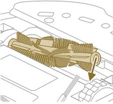
8 Setzen Sie die Kehrwalze in der richtigen Position ein. Richten Sie den quadratischen Stift am quadratischen Loch aus, und bringen Sie die Bürste in Position.
