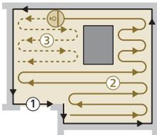
O robot limpa a casa de forma estruturada. O robot limpa uma divisão de cada vez e começa a limpeza pelas extremidades da divisão antes de limpar a superfície restante.
