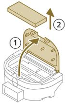
3 Åpne lokket på det vaskbare filteret og trekk ut det vaskbare luftfilteret.
