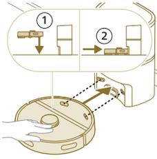
**3** Poussez le robot contre la station de sorte que les points de contact de charge du robot soient en contact avec ceux de la station.
