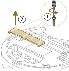
3 Desserrez les vis du couvercle du compartiment de la batterie et retirez-le.
