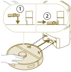
**3** Duw de robot tegen het station zodat de oplaadcontacten van de robot contact maken met de oplaadcontacten van het station.
