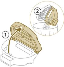
3 Open het deksel van het uitwasbare filter en pak het wasbare luchtfilter eruit.
