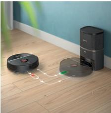
När batteriet tar slut (<20 %) under rengöring, återgår roboten automatiskt till stationen för att ladda om. Efter att batteriet har laddats fortsätter roboten där den slutade.
