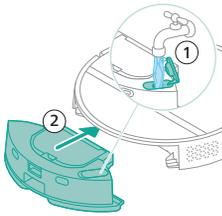
**i** Notă: Asigurați-vă că partea exterioară a rezervorului de apă este uscată.
