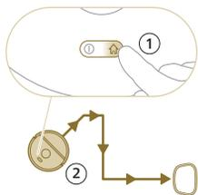
**4** Pritisnite gumb za vrnitev na postajo. Robot se zapelje na pravi položaj na postaji.
