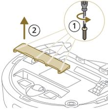
3 Allentate le viti del coperchio del vano batterie e rimuovete il coperchio.
