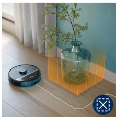
**i** **Bemærk:** Robotten kan sidde fast på tæpper med lang luv, tæpper med frynser eller meget lette tæpper som på badeværelset. Robotten kan heller ikke registrere kabler på gulvet.
