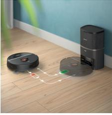
Cuando la batería está baja (<20 %) durante la limpieza, el robot regresa automáticamente a la base para recargarse. Después de cargar la batería, el robot continuará donde lo dejó.
