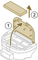
4 Spülen Sie den Feinstaubfilter mit Wasser aus, und lassen Sie ihn an der Luft trocknen.
