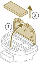
4 Spoel het uitwasbare filter uit met water en laat het aan de lucht drogen.
