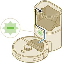
Otomatik boşaltma istasyonu robotun toz haznesini boşaltıyordu. Robottaki toz ve kir, istasyonun toz torbasında toplanır.
