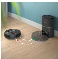
Ha az akkumulátor töltöttségi szintje alacsony (<20%) lesz takarítás közben, a robotporszívó automatikusan visszatér az állomásra tölteni. Az akkumulátor feltöltése után a robotporszívó ott folytatja, ahol abbahagyta.
