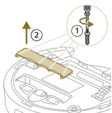
3 Odkręć śruby pokrywy komory akumulatora i zdejmij pokrywę.
