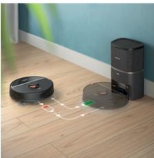
Når batteriet bliver lavt (< 20 %) under rengøring, vender robotten automatisk tilbage til stationen for at genoplade. Efter at batteriet er blevet opladet, fortsætter robotten, hvor den slap.
