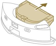
2 Abre la tapa del depósito de polvo y deja salir la suciedad del depósito de polvo.
