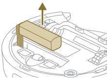
4 Estraiete la batteria ricaricabile e scollegatela premendo il fermo sul relativo connettore per sganciare il connettore.
