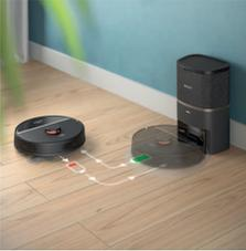
Temizlik sırasında pil seviyesi düşerse (<%20) robot, yeniden şarj olmak için otomatik olarak istasyona geri döner. Robot, pil şarj olduktan sonra temizliğe kaldığı yerden devam eder.
