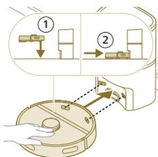
**3** Robota potisnite na postajo, da se kontakta za polnjenje na robotu dotakneta kontaktov za polnjenje na postaji.
