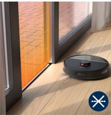
**i** Opmerking: de robot kan vastlopen in hoogpolig tapijt, vloerbedekking met rafelranden of zeer lichte kledjes, zoals in de badkamer. De robot kan ook geen snoeren op de vloer detecteren.
