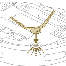
4 Bringen Sie die Seitenbürste an, indem Sie sie in der richtigen Position an der Unterseite des Roboters befestigen (hörbares Einrasten).
