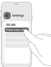
**i** Napomena: ako gumb za pridruživanje nije vidljiv u aplikaciji, napustite aplikaciju i idite na Wi-Fi u dijelu „Postavke“ na svom mobilnom uređaju. Ondje možete odabrati mrežu „**Philips robot**“ i povezati se s njom.
