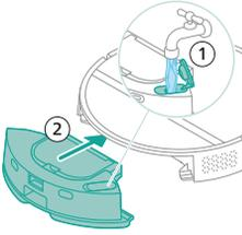
8 Verwijder het waterreservoir van de water inlaat. Plaats het waterreservoir op de juiste plaats.
