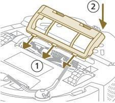
9 Setzen Sie die Laschen der Abdeckung der Bürstenwalze in die richtigen Aussparungen.
