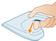
2 松开蒸汽开关，停止喷射蒸汽。
