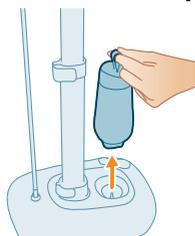
1 Снимите резервуар для воды с основания прибора.
