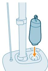
**17** Установите резервуар для воды в основание прибора.
