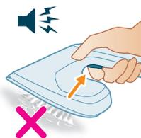
**2** Druhý krok, který žehličku chrání před vodním kamenem, je integrován: pokud neproběhne odstraňování vodního kamene, funkce napařování se deaktivuje. Po odstranění vodního kamene se funkce napařování obnoví. Tento proces probíhá bez ohledu na typ použité vody.
