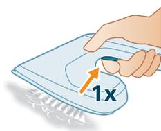
3 按下蒸汽开关一次以关闭蒸汽锁模式。
