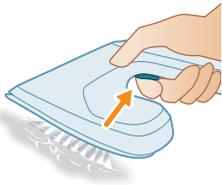
2 دکمه فشاری بخار را رها کنید تا خروج بخار متوقف شود.
