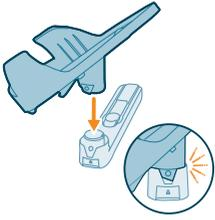
**15** Inserte la base en el brazo de la base de la plancha hasta oír un "clic".
