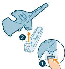
3 È possibile utilizzare il supporto del ferro con l'orientamento a sinistra (tutti i modelli).
