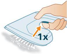
3 Premere il pulsante del vapore una volta per interrompere la modalità blocco del vapore.
