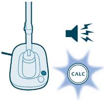
2 علاوه بر این، گام دوم جهت حفاظت از دستگاه در برابر رسوب انجام می‌شود: اگر رسوب‌زدایی دستگاه انجام نشده باشد، عملکرد بخار غیرفعال می‌شود. پس از اینکه رسوب‌زدایی انجام شد، عملکرد بخار بازیابی می‌شود. این کار بدون توجه به نوع آبی که استفاده می‌شود، انجام می‌گردد.
