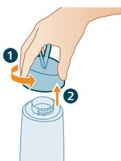
2 Выкрутите и снимите крышку резервуара для воды.
