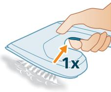
**3** Нажмите кнопку подачи пара один раз для отключения режима блокиратора пара.
