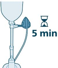
1 Thiết bị được trang bị tính năng tự động ngắt điện. Tính năng này sẽ được kích hoạt khi thiết bị không được sử dụng trong 5 phút.
