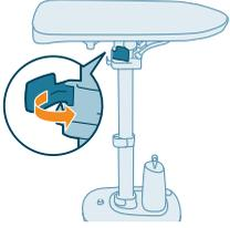
2 Ütü platformu kolu düğmesine basın ve ütü platformunu çıkarın.
