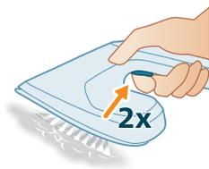
1 Nyomja meg kétszer gyorsan a gőzvezérlőt.
