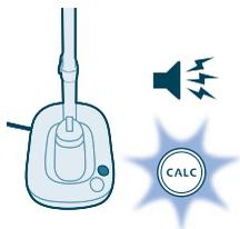
**1** Po 1 až 3 měsících používání začne kontrolka Calc-Clean blikat a zařízení bude pípáním upozorňovat na to, že je třeba provést proces odstranění vodního kamene.
