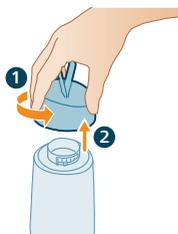
2 Skruva ur och ta bort vattenbehållarlocket.
