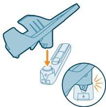
**15** Befestigen Sie die Station an der Halterung, bis sie hörbar einrastet.
