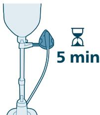
1 L'appareil est équipé d'une fonction d'arrêt automatique. Cette fonction est activée lorsque l'appareil n'est pas utilisé pendant 5 minutes.
