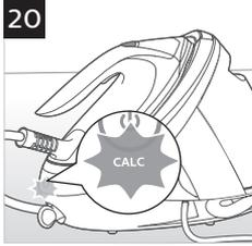
**EASY DE-CALC шамы жыпылықтай бастағаннан және құрылғы дыбыс сигналын үздіксіз шығарғаннан EASY DE-CALC (20-сурет) функциясын пайдалану керек.**
