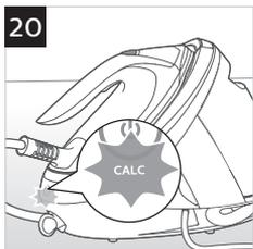
**Bardzo ważne jest, aby użyć funkcji EASY DE-CALC, gdy wskaźnik EASY DE-CALC się zaświeci (rys. 20), a urządzenie emituje ciągły sygnał dźwiękowy.**
