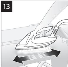
Интеллектуалдык автоматтык буу режиминде, буу үтүктү кыймылдатканыңызда автоматтык түрдө чыгып, үтүктү кыймылданууну токтотсоңуз, автоматтык түрдө токтойт (Сүр. 13). Ошондой эле бул режимде үтүк кыймылдабай турганда бууну чыгаруу үчүн буу чыгаруу машасын бассаңыз болот.
