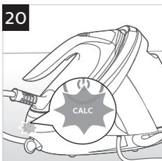
**Ir ļoti svarīgi izmantot EASY DE-CALC funkciju, tiklīdz sāk mirgot EASY DE-CALC indikators (20. att.) un ierīce nepārtraukti pīkst.**
