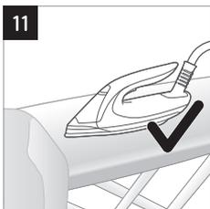
Triikimise ajal saate triikraua asetada kas alusele või horisontaalselt triikimislauale. Tänu ActiveSense tehnoloogiale ei kahjusta triikraua tald triikimislaua katet (joonis 11).
