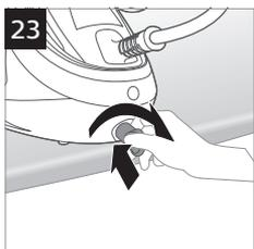
5 Kiedy woda przestanie wypływać z urządzenia, załóż ponownie pokrętło EASY DE-CALC i dokręć je w prawo (rys. 23).
