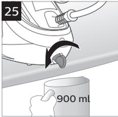
**25** EASY DE-CALC düğmesinin altına bir kap (en az 900 ml) yerleştirin ve düğmeyi saat yönünün tersine çevirin (Şek. 25).
