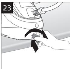
**5** Когда из прибора перестанет поступать вода, установите клапан EASY DE-CALC на место и поверните его по часовой стрелке для фиксации (рис. 23).
