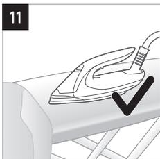
Ütükleýän wagtyňyz ütügeni platformasynyň üstünde ýa-da ütük tagtasynyň üstünde keseligine ýerleşdirip bilersiňiz. ActiveSense tehnologiýasy arkaly ütügeni dabany ütük tagtasynyň örtüğine zeper ýetirmeýär (Şekil 11).
