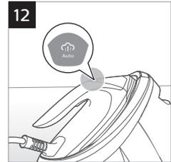
Pri načinu pametnega samodejnega izpusta pare izpuščanje pare med premikanjem likalnika poteka samodejno ter se prekine, ko likalnik miruje (slika 13). Če želite v tem načinu vklopiti paro, ko likalnik miruje, pritisnite sprožilnik pare.
