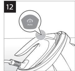
Nutika automaatse aururežiimi aktiveerimisel tuleb aur automaatselt välja, kui liigutate triikrauda, ja peatub, kui jätate triikraua seisma (joonis 13). Kui soovite auru kasutada siis, kui triikraud seisab, siis vajutage aurunuppu.
