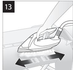
**Забележка:** За ваша безопасност в режима за интелигентна автоматична пара парата спира при повдигане на ютията.
