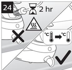
**Da se izognete opeklinam, izvlecite vtič aparata iz vtičnice in počakajte, da se vsaj dve uri ohlaja, preden opravite postopek odstranjevanja vodnega kamna iz likalne plošče (slika 24).**
