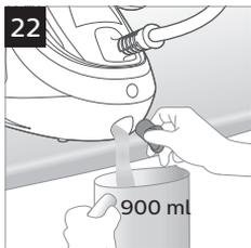
**4** Снимите клапан EASY DE-CALC и слейте воду с частицами накипи в чашку (рис. 22).
