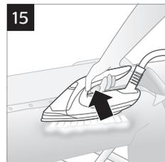
**Piezīme.** Lai sasniegtu vislabākos rezultātus uz zīda un mirdzošiem sintētiskiem audumiem, gludināšanas laikā ieteicams turēt tvaika slēdzi nepārtraukti nospiestu.
