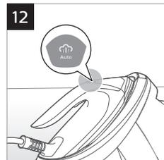
Az intelligens automatikus gőz üzemmódban a gőz automatikusan kiáramlik a vasaló mozgásakor, illetve leáll a gőzkibocsátás, ha megállítja a vasalót (13. ábra). A gőz aktiválásához le is nyomhatja a gőzvezérlő gombot ebben a módban, ha a vasaló nem mozog.
